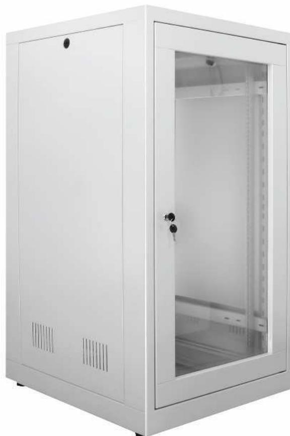
Fechamentos laterais e traseiros removíveis em chapa de aço SAE 1010 **(#20) 0,90mm,** com travamento através de fecho rápido (tipo fenda). Racks de 36Us ou mais e com profundidades de 900mm ou superior, terão coluna lateral vertical em chapa de aço SAE 1010/1020 **(#18) 1,2mm,** reforçando a estrutura do rack, dividindo as laterais em duas peças.
