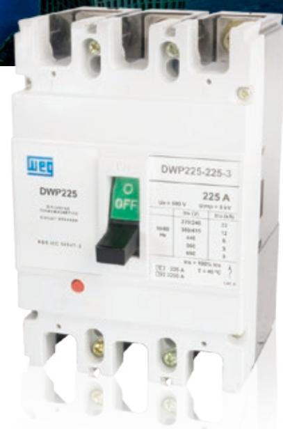
Desenvolvidos na versão tripolar, os disjuntores em caixa moldada DWP **protegem os circuitos de distribuição de baixa tensão de 100 a 225 A contra curto-circuito e sobrecarga**, de acordo com a norma NBR IEC 60947-2. A linha conta ainda com disparador térmico e magnético fixos e prensa cabos como acessórios, possibilitando conexão direta de cabos de até 120 mm<sup>2</sup>.
